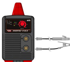
Per saldare in c.c. polo negativo, invertire i collegamenti sulla macchina in modo da avere il cavo elettrodo collegato a (-) e il cavo al giunto da saldare a (+).
